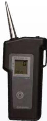
Appareil de contrôle par ultrasons PM11
