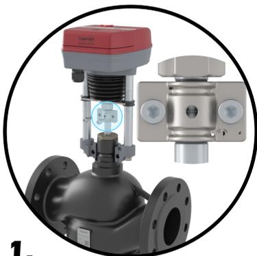
1. Desserrez le coulisseau et la pince, puis placez l'actionneur sur le corps de la vanne en veillant à ce que les deux faces de connexion coïncident. Fixez les vis sur la fente à l'aide de la clé Allen.
